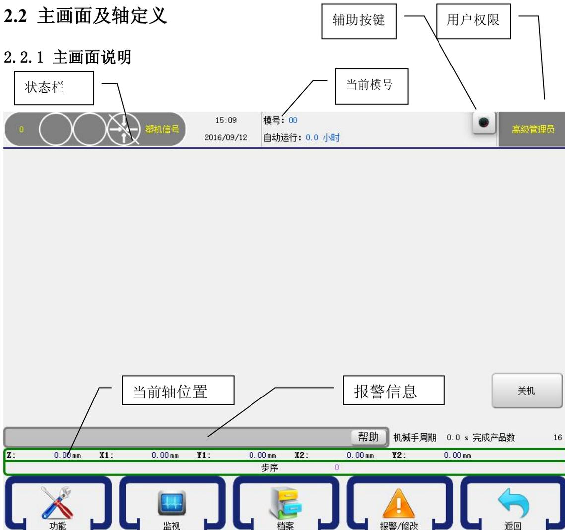
**状态栏:** 显示手动，自动，停止，原点的状态。
