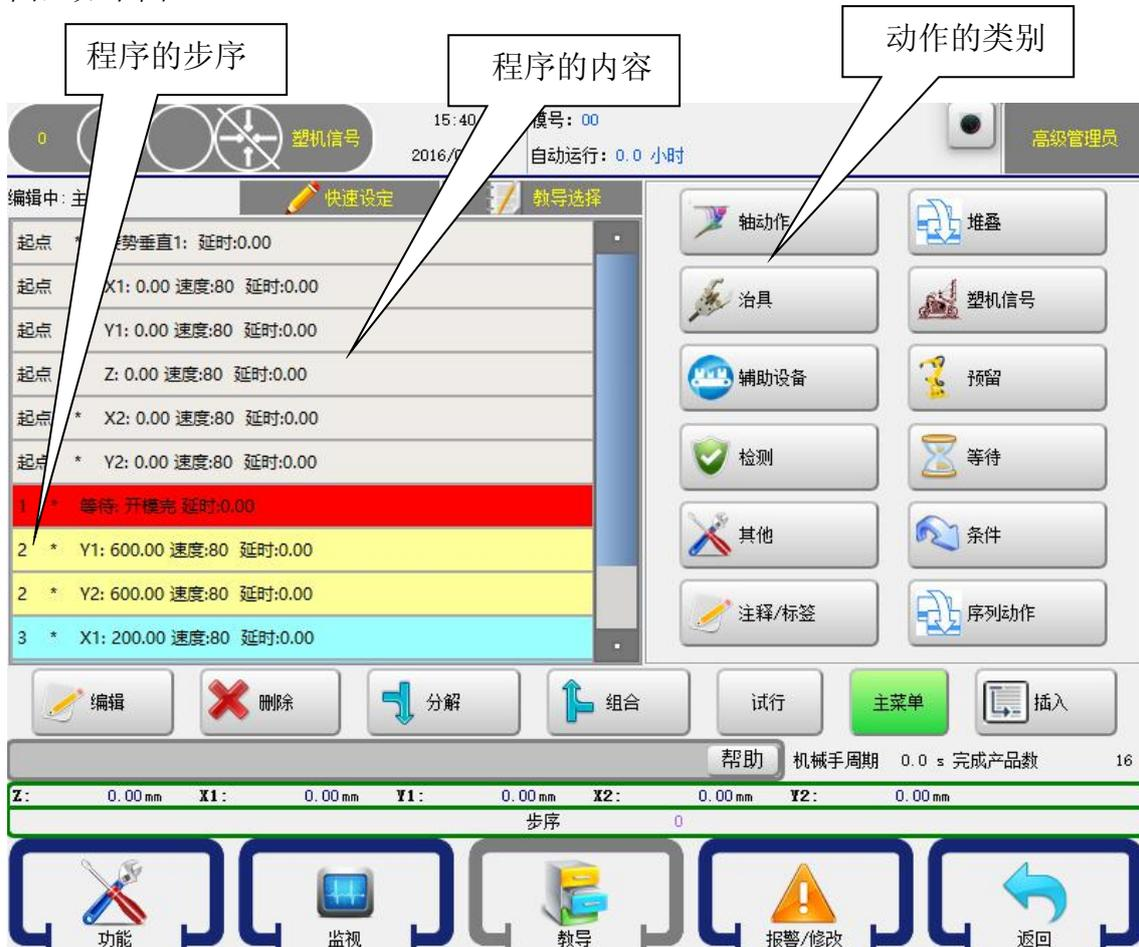
动作菜单将程序的编辑分为“轴动作”、“堆叠”、“治具”、“塑机信号”、“辅助设备”、“预留”、“检测”、“等待”、“其他”、“条件”、“注释/标签”、“序列动作”。点击相应的按钮即可进入该类动作的教导页面，点击【主菜单】按钮返回至教导动作的主画面。
