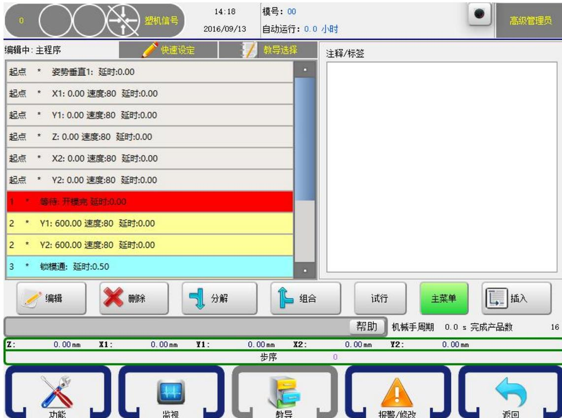
点击注释的空白栏，会自动弹出输入框，在框内输入注释内容（点击CH可以进行中英文切换），之后点击ENT键，然后将注释插入相对应的程序步之前。输入框如下：
