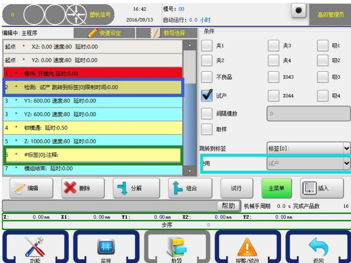
如上图所示，试产有专门的子程序进行跳转。试产有模数可以设定，详见 [5.2 产品设定](#)。试产模数的设定。
