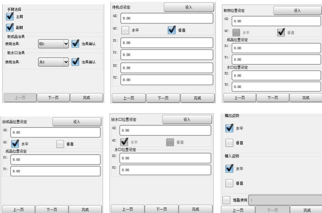
如上图所示，程序快速设定，可以只设定位置和选择动作。程序即可自动生成可执行的程序。省去一步一步教导的繁琐！
