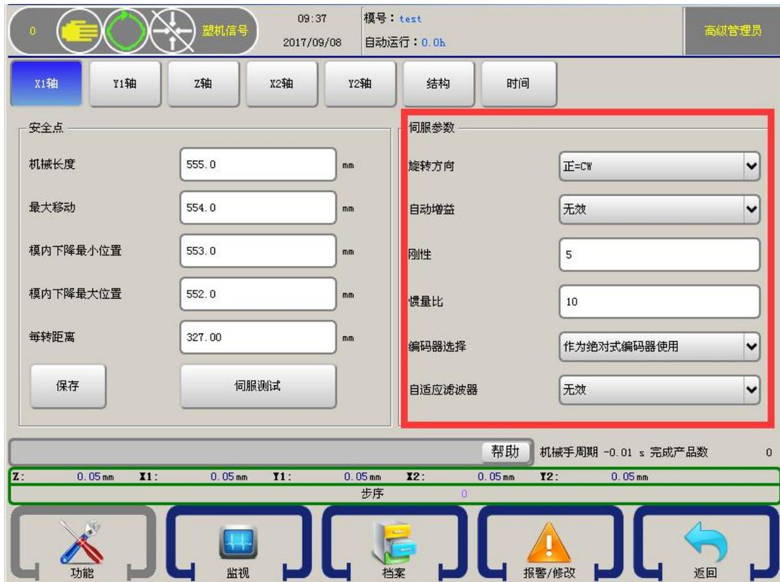
正常连接伺服电机后手控器的伺服参数设置页面可显示出各伺服轴的旋转方向、自动增益、刚性、惯量比、编码器选择、自适应滤波器这6个参数的设定情况，在此界面下用户可通过对这6个参数做更改从而去更改伺服上所对应的参数。
