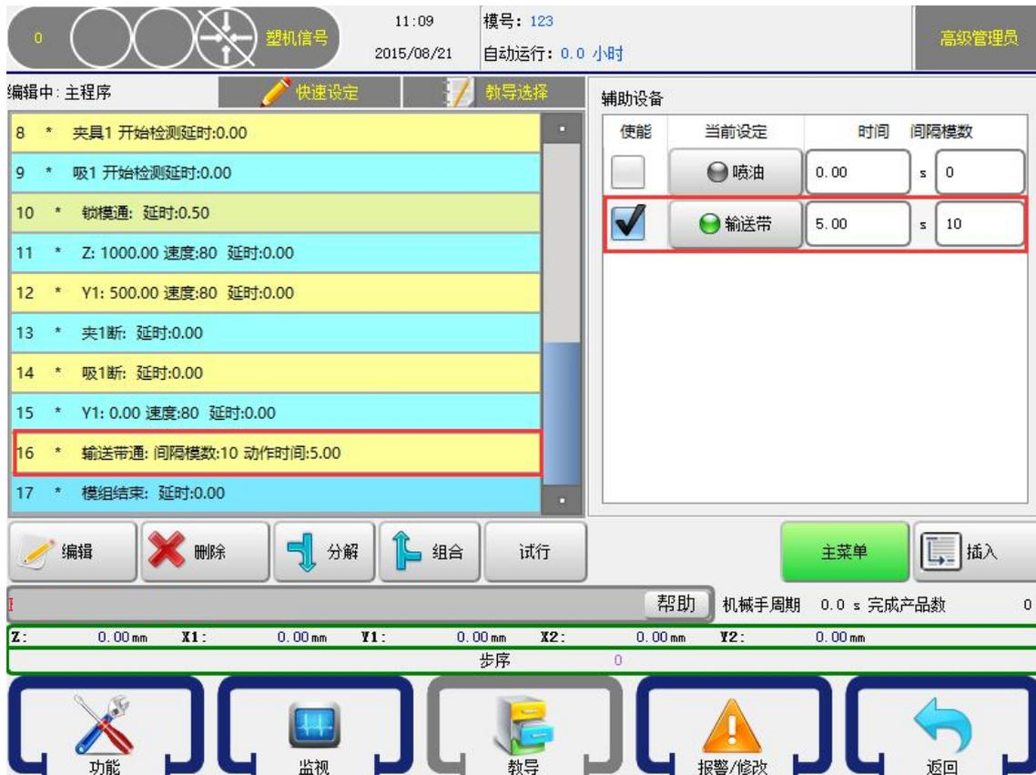
点击所要控制的喷油或输送带按钮，该喷油或输送带即输出同时按钮上的指示灯即变成绿色。再点击左边的使其变成，再点击【插入】按钮将该动作插入到所选择程序步的前面。
